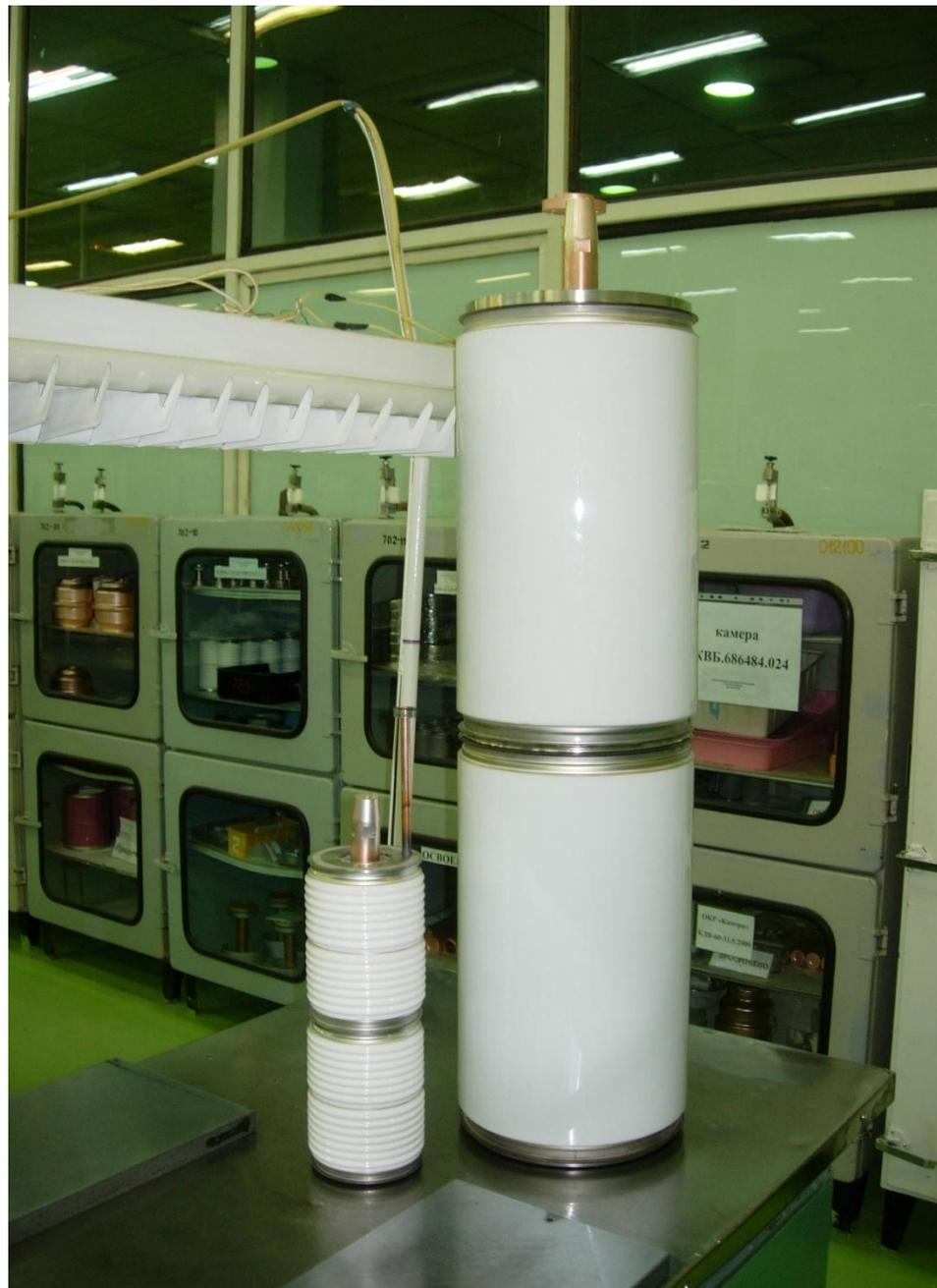
**С использованием вакуумной камеры на напряжение 110 кВ могут быть разработаны и изготовлены:**
