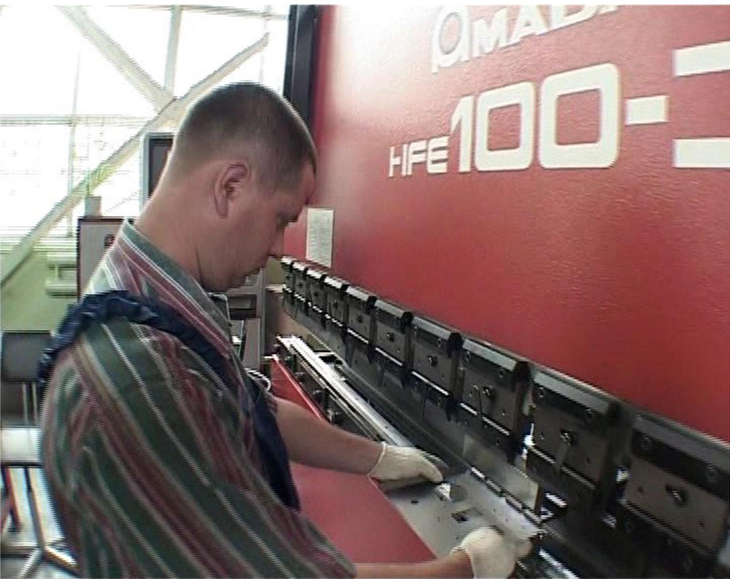
Гибочные операции выполняются на установки гибки HFE 100 – 3 фирмы Amada (Япония).
