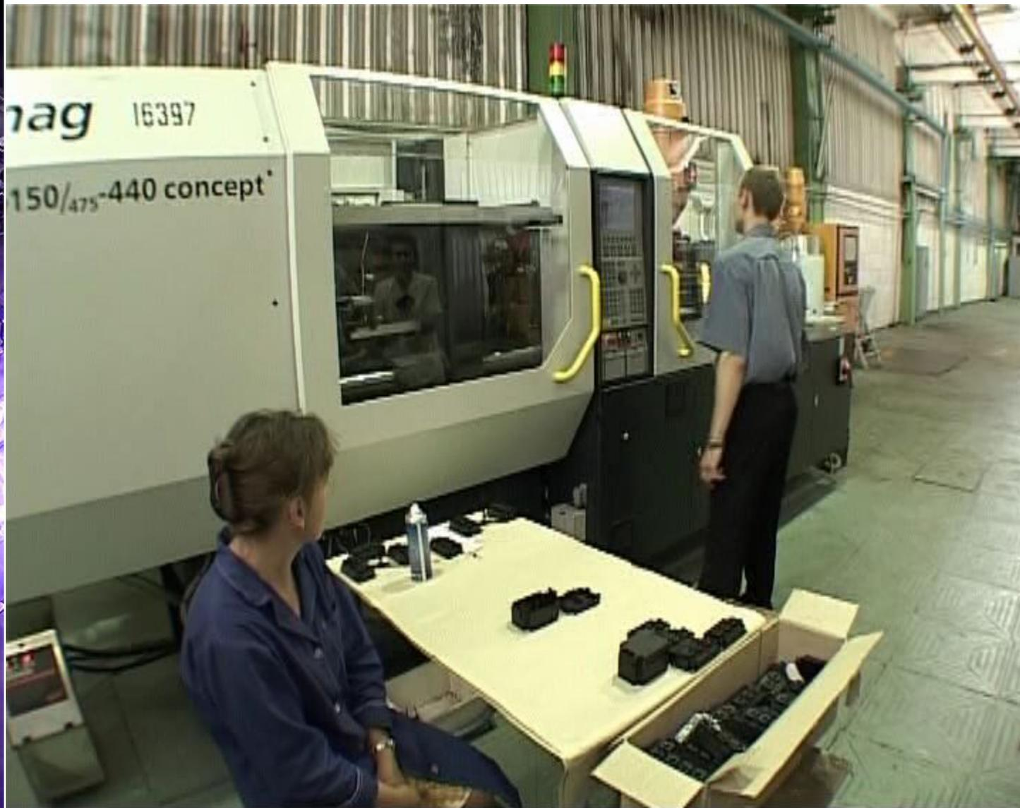
На изготовление пластмассовых корпусов и крышек IGBT-модулей задействован термопластавтомат ERGOtech concept 150/475 – 440 фирмы Demag (Германия).
