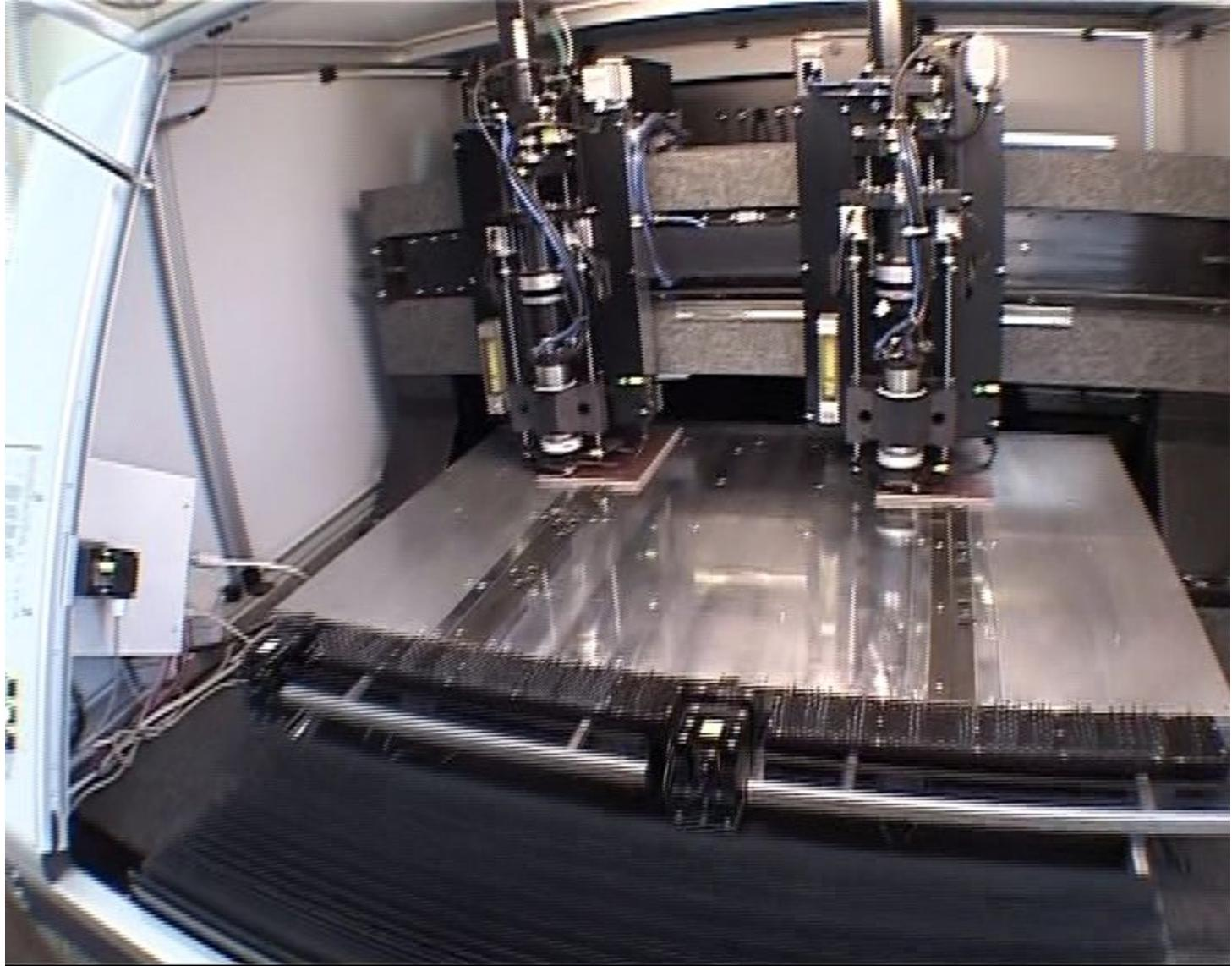
Основой любого блока являются печатные платы, производство которых за последние годы модернизированы до уровня возможности производства плат 4-5 класса. В частности, приобретен сверлильно-фрезерный станок Alpha – 02 фирмы Klingelnberg (Германия).
