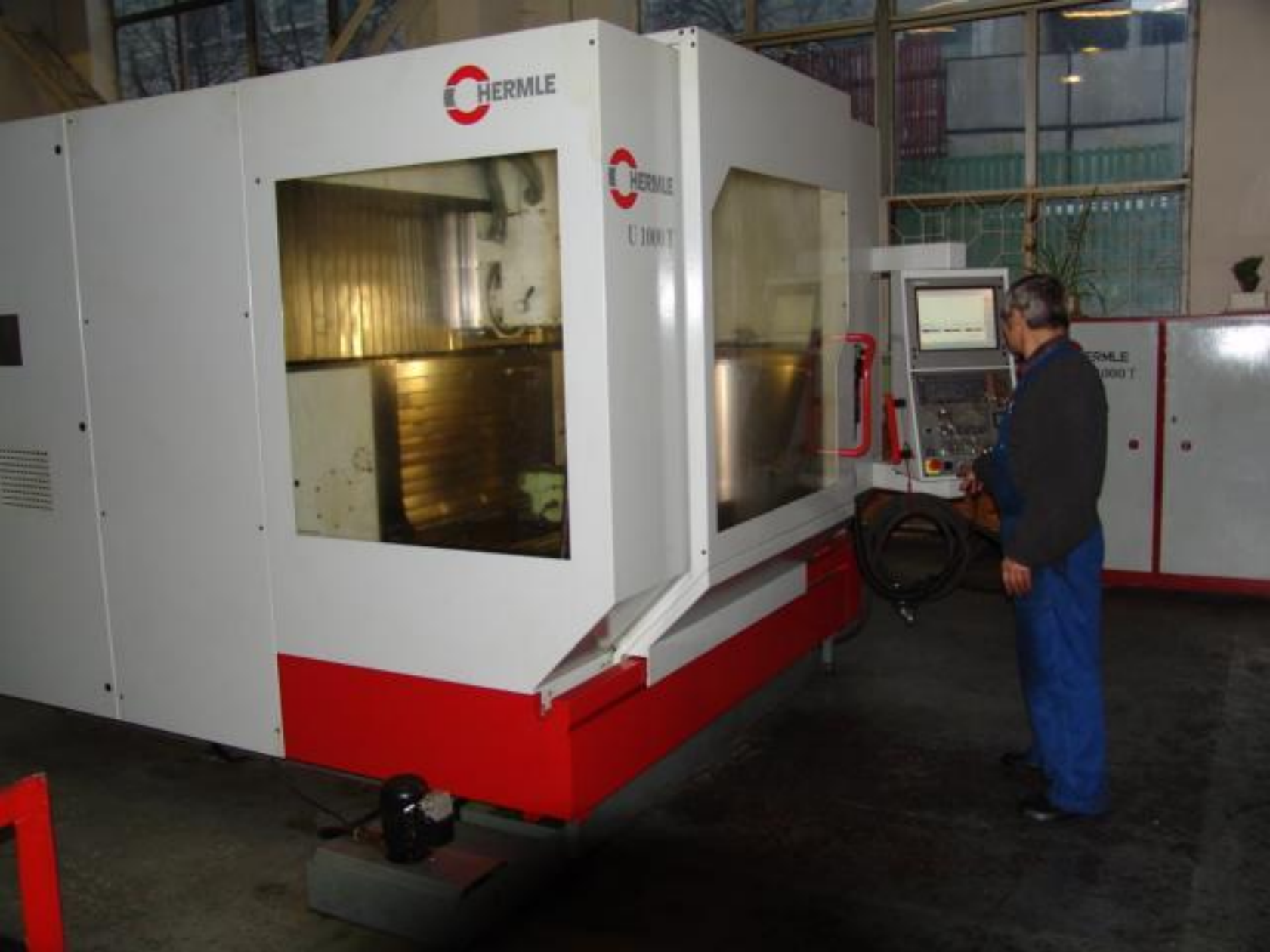
Сверлильно-фрезерные операции на моноблоках охлаждения и модульных основаниях производятся на сверлильно-фрезерном центре HERMLE U 1000T (Германия).
