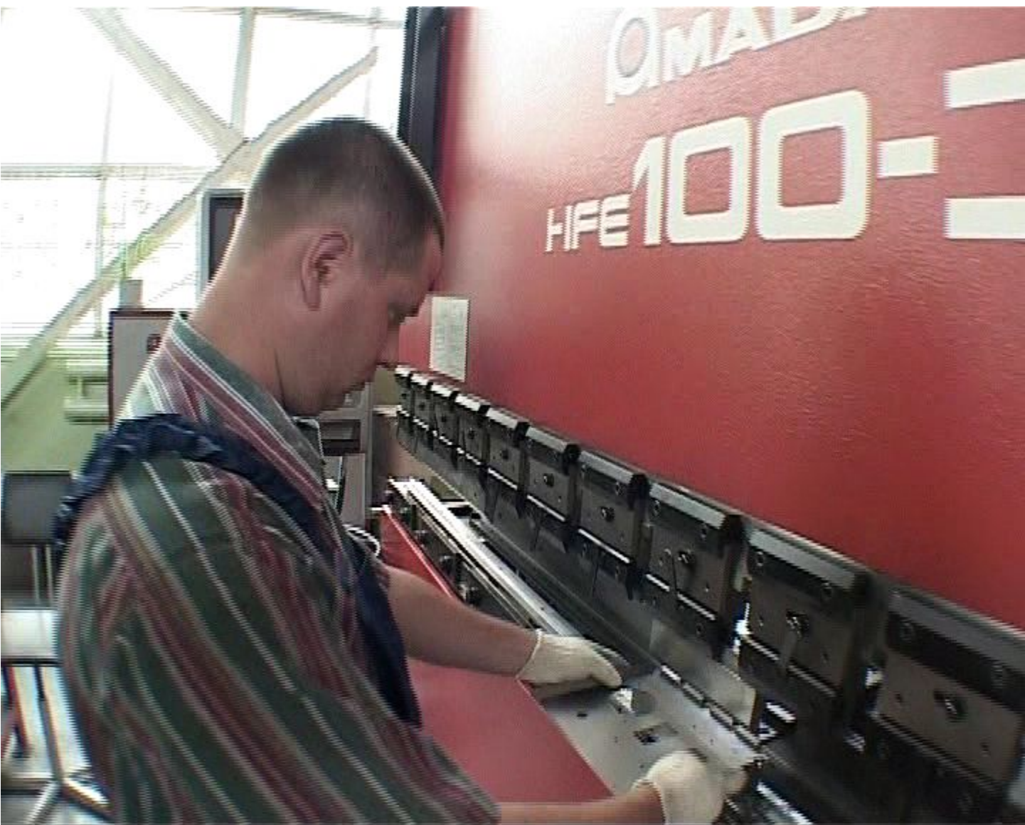
Гибочные операции выполняются на установки гибки HFE 100 – 3 фирмы Amada (Япония).
