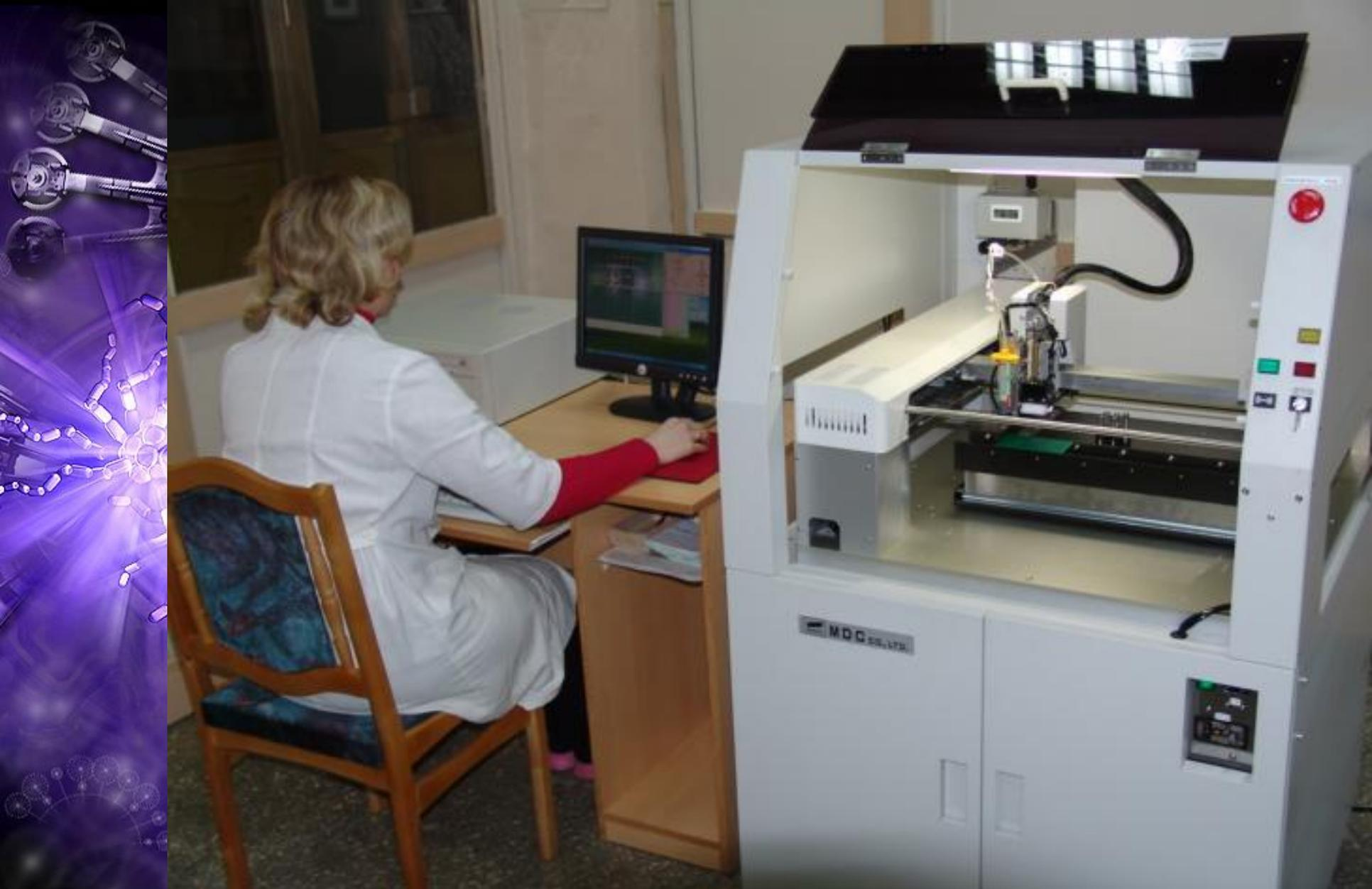
Линия поверхностного монтажа блоков автоматики начинается с автомата дозирования паяльной пасты ECM 25 DD фирмы M.D.C. (Япония).
