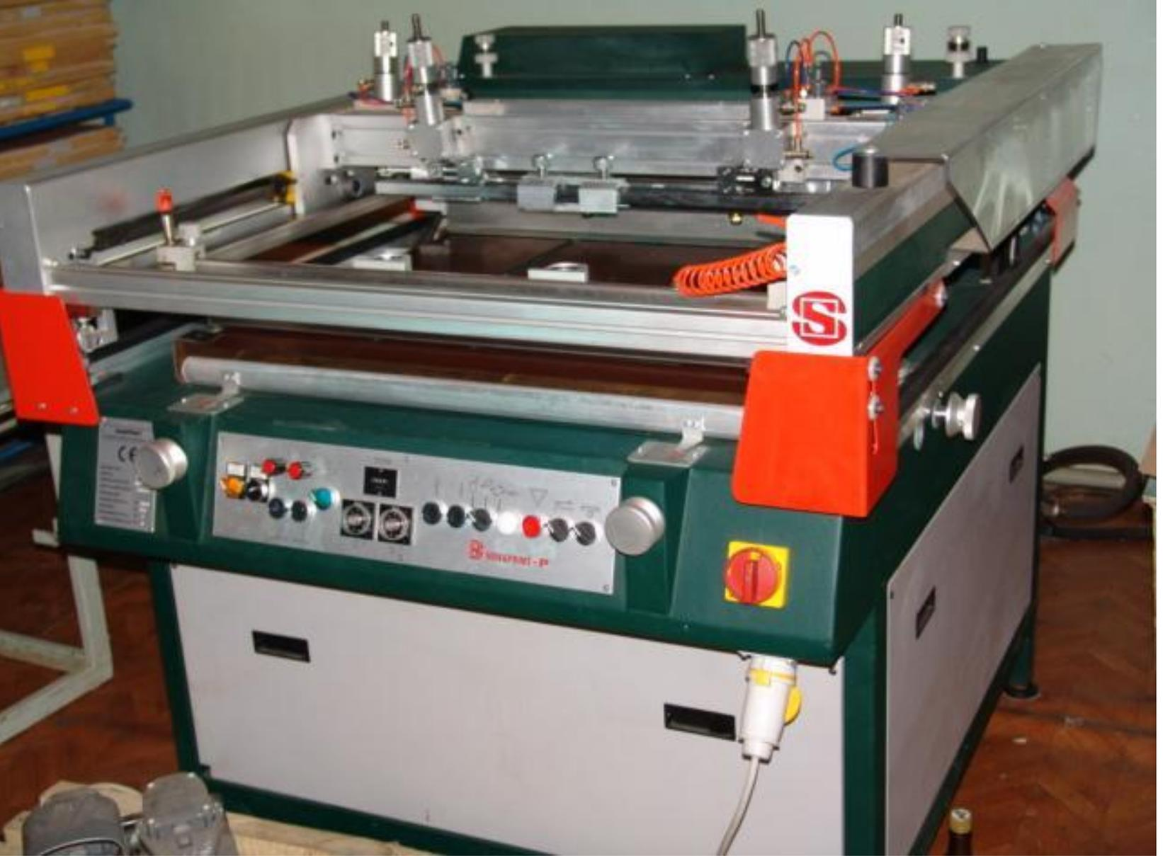
Нанесение защитной паяльной маски и маркировки на печатных платах производится на полуавтоматах Novaprint и Beltron фирмы Siasprint (Италия)
