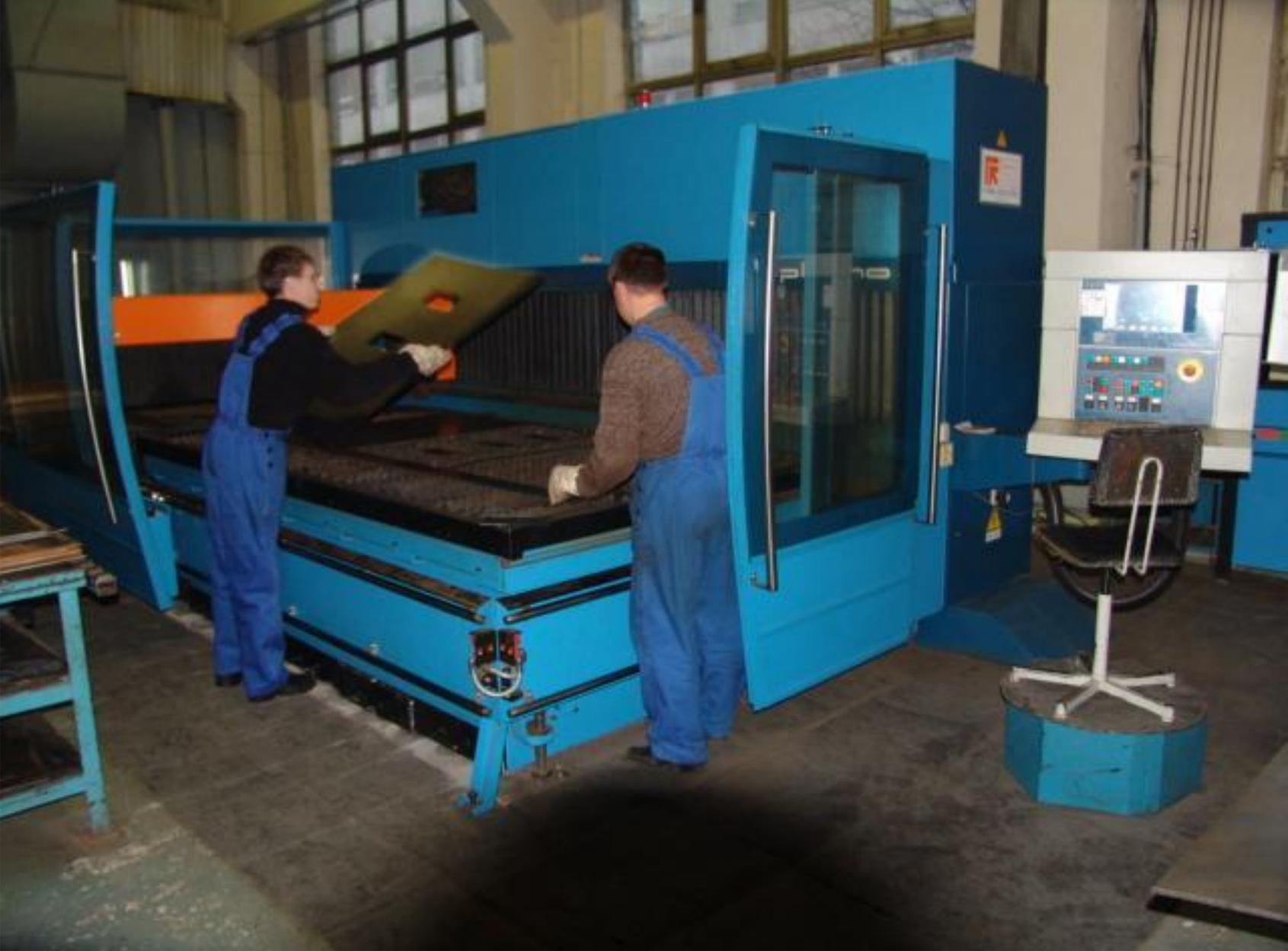
С 2001 года раскрой листовой стали толщиной до 6 мм производится на установке лазерной резки Platino 1530 фирмы Prima Industri (Италия).
