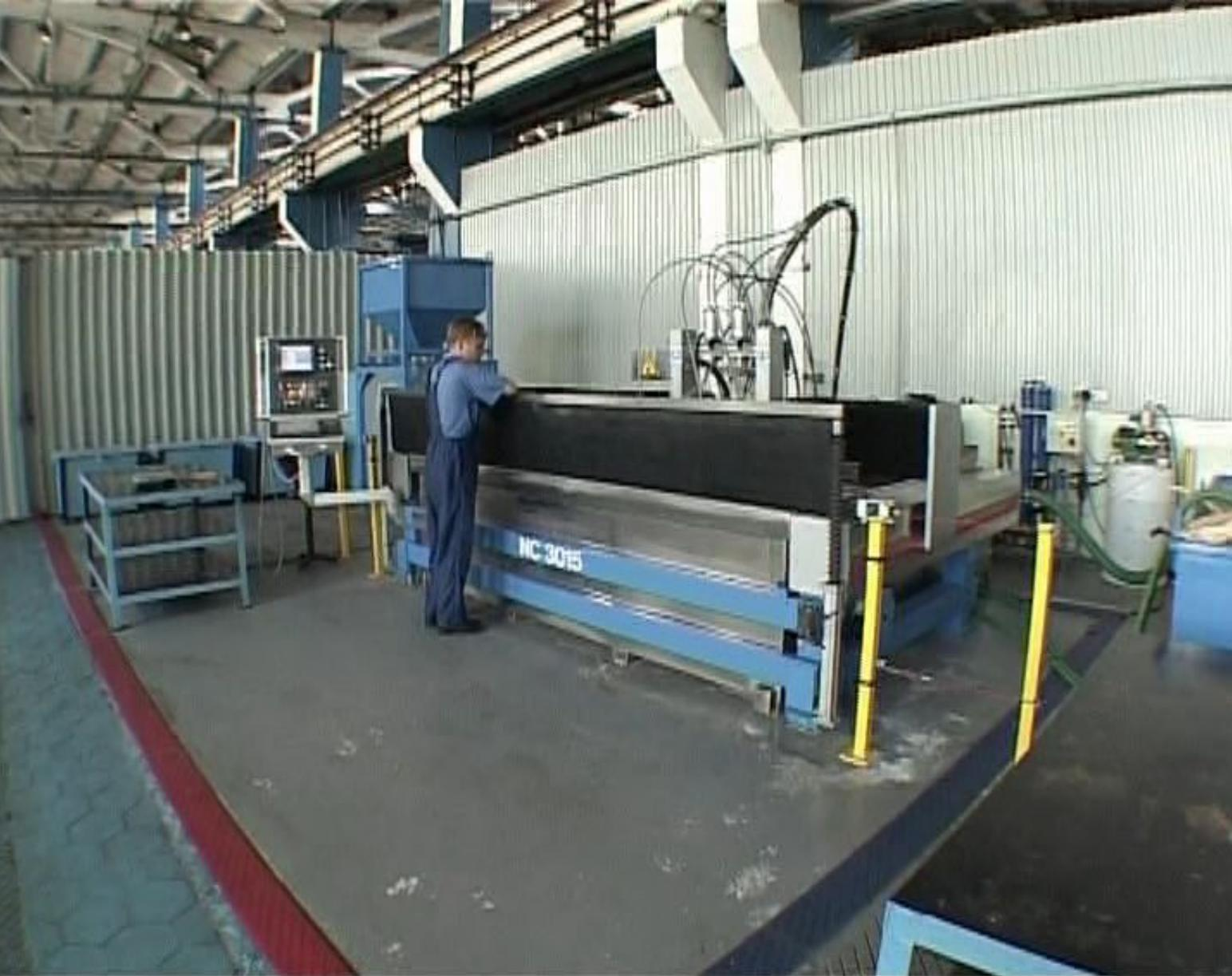
На раскоре любых листовых материалов толщиной до 150 мм (медь и ее сплавы, стеклотекстолит, сталь, стекло и т.д.) применяется установка гидроабразивной резки NC 3015 фирмы Water Jet Schweden (Швеция)
