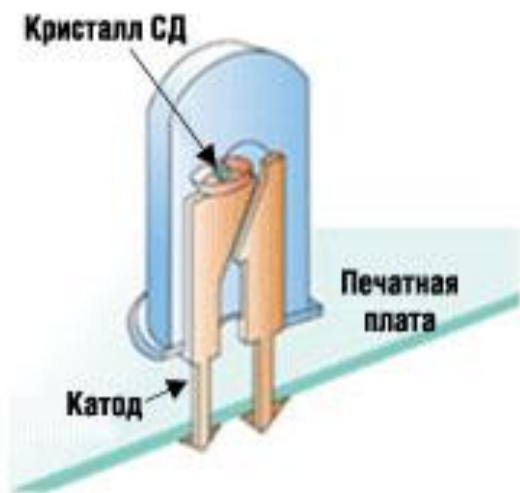
Конструкция обычного 5 мм светодиода
