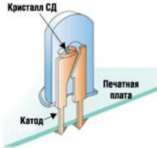
Конструкция обычного 5 мм светодиода
