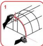
1 ПРИ ПОМОЩИ РУЛЕТКИ ПРОИЗВОДИМ ЗАМЕР ВНЕШНЕЙ ДУГИ, ВКЛЮЧАЯ ОБА ОСНОВАНИЯ.
