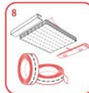
8 ПОСЛЕ СБОРКИ ТЕПЛИЦЫ ПРОИЗВОДИМ ГЕРМЕТИЗАЦИЮ ВСЕХ ТОРЦОВ ЛИСТА ПРИ ПОМОЩИ ПЕРФОРИРОВАННОЙ ЛЕНТЫ И ТОРЦЕВОГО ПРОФИЛЯ.
