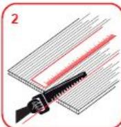
2 ПОЛУЧЕННЫЙ РАЗМЕР ОТРЕЗАЕМ НА РАВНОЙ ПОВЕРХНОСТИ ПО ЛИНЕЙКЕ С ЗАПАСОМ ОКОЛО 10 см.
