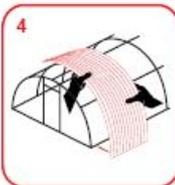
4 НА ДУГИ УЛОЖИТЬ ЛИСТ МАРКИРОВАННОЙ СТОРОНОЙ ВВЕРХ, ПРЕДВАРИТЕЛЬНО СНЯВ ПРОЗРАЧНУЮ ЗАЩИТНУЮ ПЛЕНКУ С ВНУТРЕННЕЙ СТОРОНЫ ЛИСТА ТАКИМ ОБРАЗОМ, ЧТОБЫ КРАЙ ЛИСТА ВЫСТУПАЛ НАД ТОРЦОМ НА 50-60мм.
