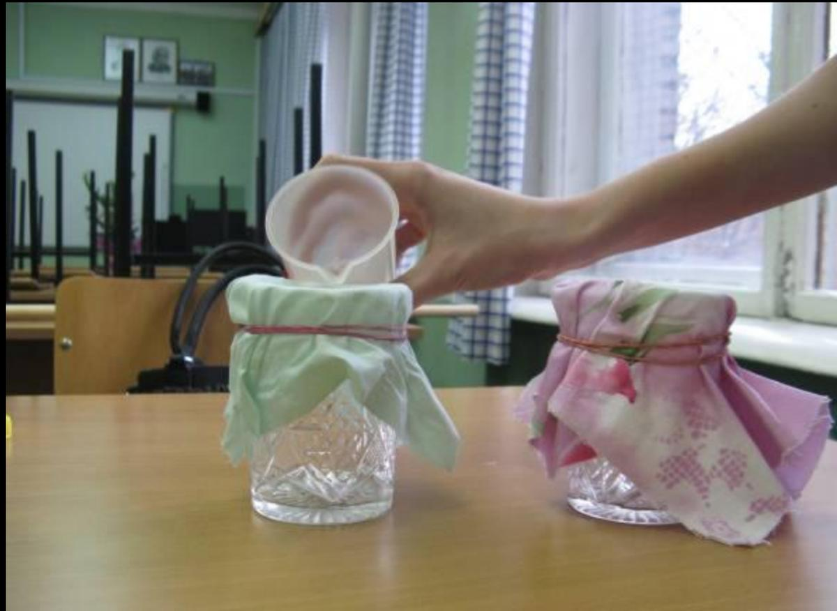
Смотрим какая ткань промокнет быстрее. Это зависит от структуры и плотности ткани, на которую наливают воду.
