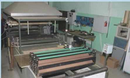
Получение препрегов методом интенсивной пропитки наполнителя (стеклянных, базальтовых или углеродных тканей) расплавом полимерного связующего:
