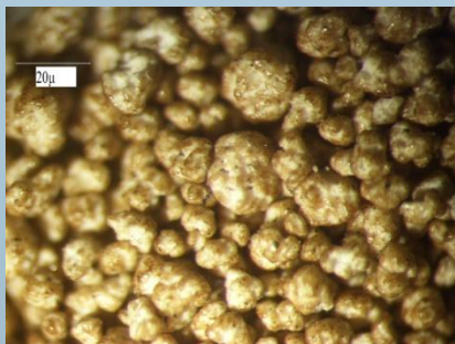
Смесь порошкообразного ПФС с крупностью зерен 20μ и концентрацией наномодификатора 0,1%.
