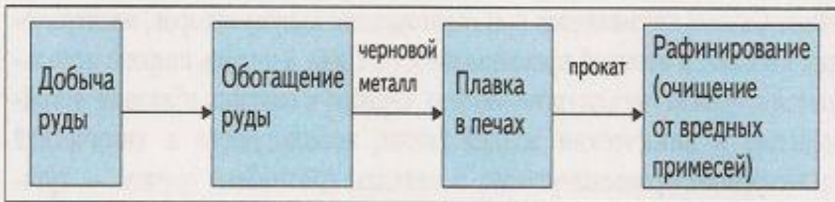
Рис. 32. Технологическая цепочка в цветной металлургии
