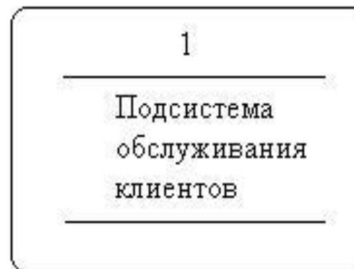
**Процессы.** Представляет собой преобразование входных потоков данных в выходные в соответствии с определенным алгоритмом.
