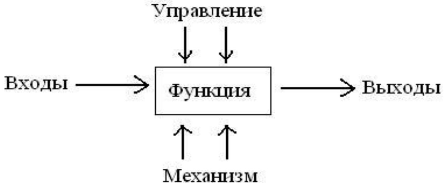
**Иерархия диаграмм.** Построение SADT-модели начинается с представления системы в виде одного блока и интерфейсных дуг функций вне системы. Далее этот блок детализируется на другой диаграмме с помощью нескольких блоков, соединенных дугами.
