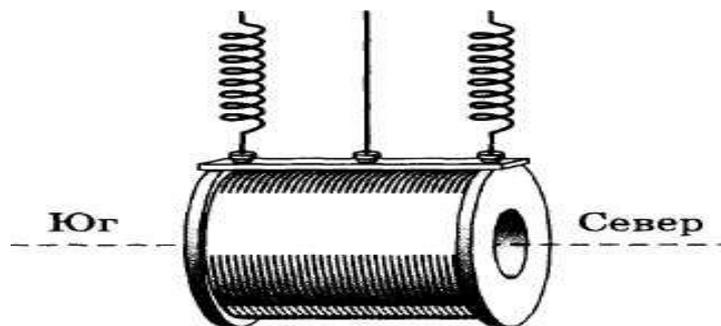
**Электромагнит** — устройство, магнитное поле которого создаётся только при протекании электрического тока.
