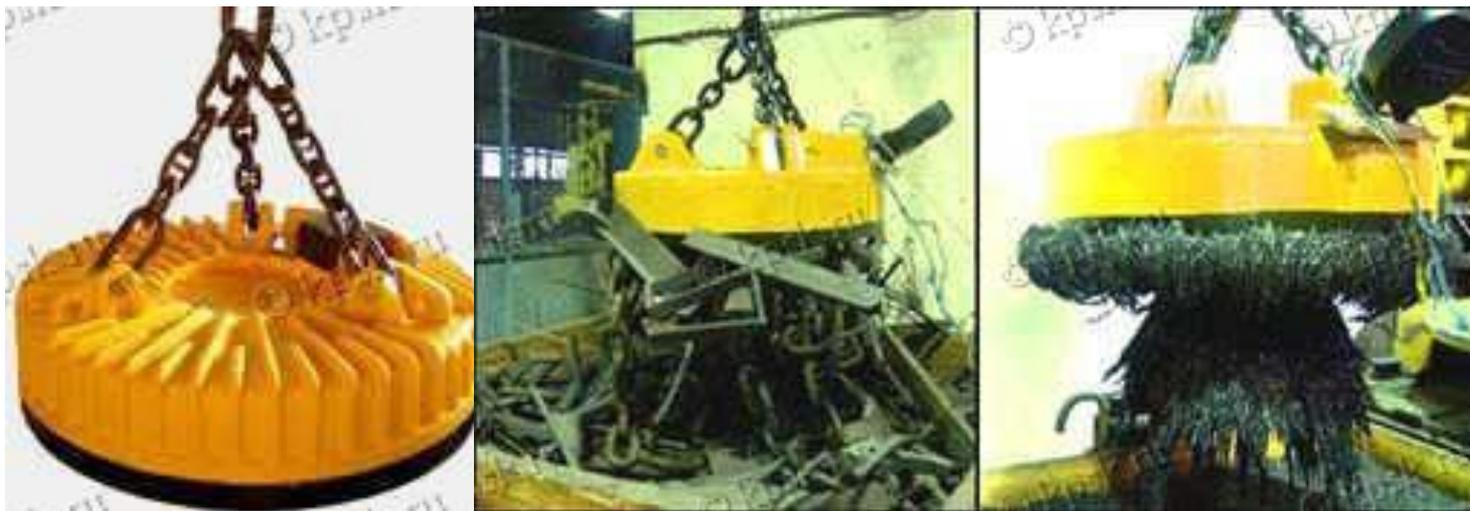
**Электромагниты, обладающие большой подъемной силой, используют на заводах для переноски изделий из стали или чугуна, а также стальных и чугунных стружек, слитков.**
