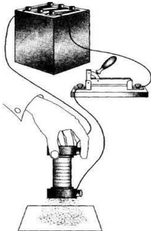
**Катушка, состоящая из большого числа витков провода, намотанного на деревянный каркас. Когда в катушке есть ток, железные опилки притягиваются к ее концам, при отключении тока они отпадают.**
