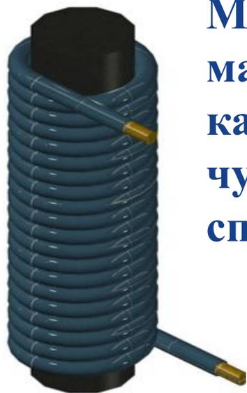
Магнитопровода изготавливают из магнитно-мягких материалов - обычно из электротехнической или качественной конструкционной стали, литой стали и чугуна, железоникелевых и железокобальтовых сплавов.
