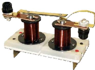
Электромагнит разборный с деталями предназначен для проведения фронтальных лабораторных работ по электричеству и магнетизму.
