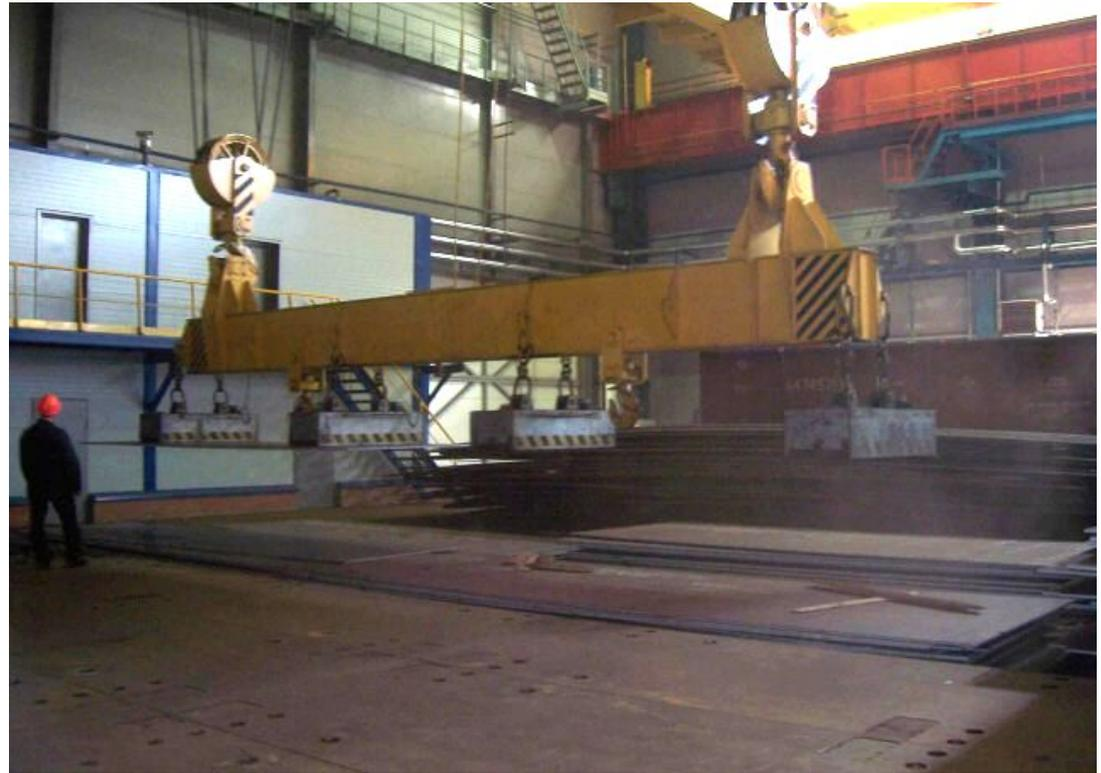
**Электромагнитные траверсы используются для перемещения длинномерных грузов.**
