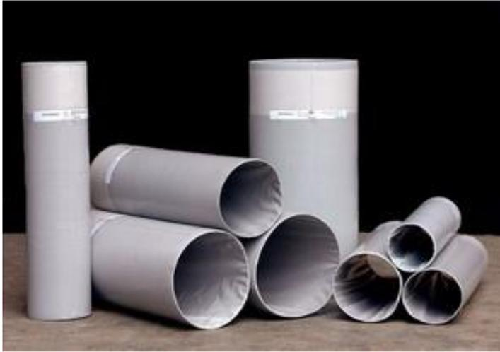
Муфты предназначены для гидроизоляции сварных стыков труб с тепловой изоляцией из пенополиуретана в полиэтиленовой оболочке и применяются при подземном бесканальном и канальном способе прокладки тепловых сетей. Муфты изготавливаются из полиэтиленовых труб, выпускаемых по ГОСТ 30732 – 2006.
