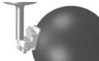
Тест надежности удержания крышки
