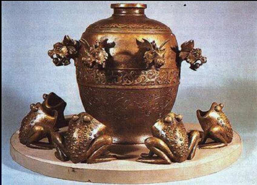
Современная реконструкция сейсмографа, изготовленного Чжан Хэном в 132 г. н.э
