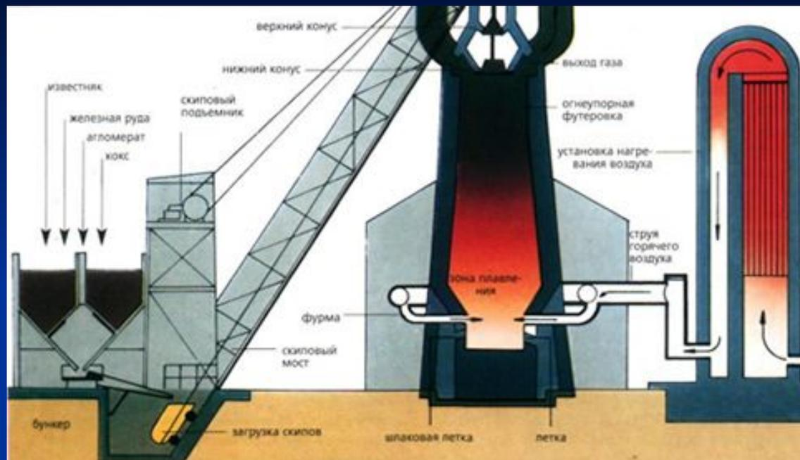
Железная руда превращается в железо в доменных печах. Печь загружается сверху смесью железной руды, кокса и известняка. Потoki горячего воздуха, проходя по печи снизу вверх, активизируют протекание химических реакций. Чугун и шлак отдельно удаляются из нижней части печи.
