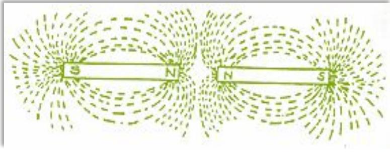
2. Магнитные линии – замкнутые линии. Вне магнита магнитные линии выходят из «N» и входят в «S», замыкаясь внутри магнита.
