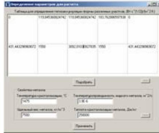
10. Расчет времени затвердевания металла с учетом перегрева.
