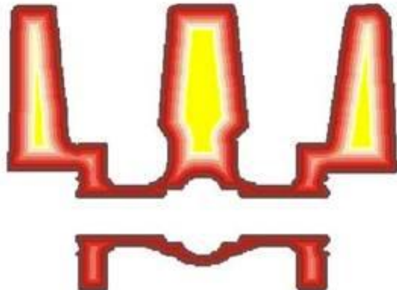
Отливка с высокими прибылями в процессе отверждения
