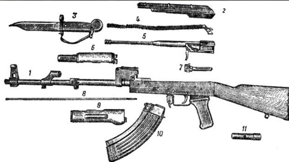
Рис. 2. Основные части и механизмы автомата:
