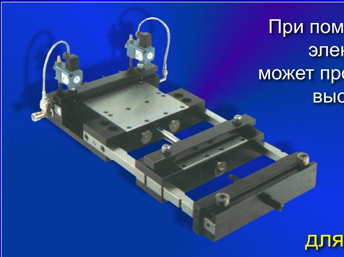
При помощи дополнительного электроклапана разжатие может производиться даже при высокой скорости подачи
