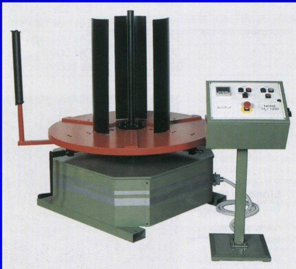
Разматывающие устройства включают в себя сварную станину, барабан с гидравлическим или ручным расширением, электропривод (или без привода), прижимной пневматический или гидравлический ролик, гидравлический подъемник рулона (или без подъемника), ультрасенсорный датчик положения ленты. Скорость вращения барабана регулируется.
