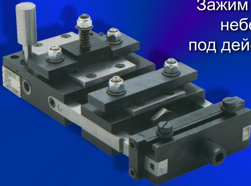
Зажим позволяет осуществлять небольшое смещение ленты под действием выравнивающего пилотного устройства
