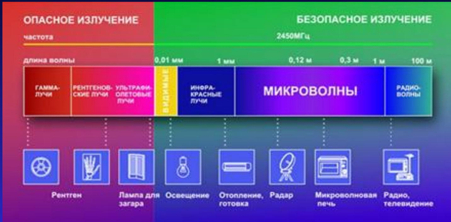
Рис.2 Шкала электромагнитного излучения
