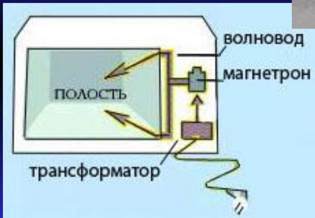
Рис.4 Магнетрон –
