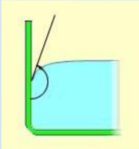
*Когда наблюдается несмачиваемость, то это означает, что молекулы жидкости притягиваются сильнее друг к другу, чем к молекулам твердого тела.*
