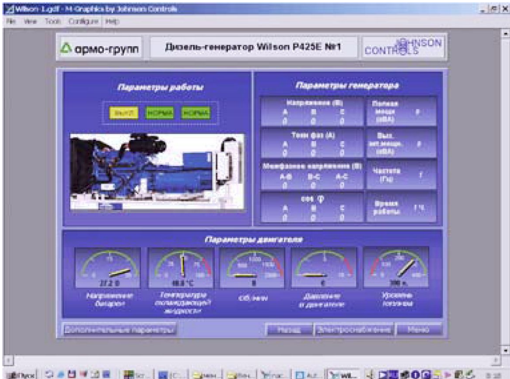
Экранная форма автономной системы управления бесперебойным электроснабжением
