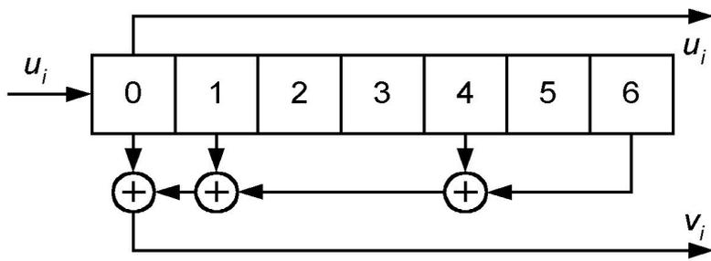
Схема порогового декодера свёрточного кода с  $R=1/2$  и  $d=5$ .
