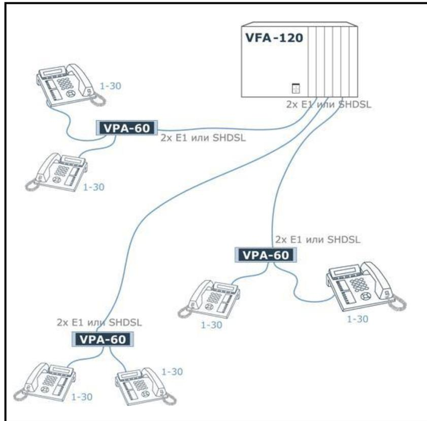
Расширение при помощи макс. 6 модулей VPA-30DT
