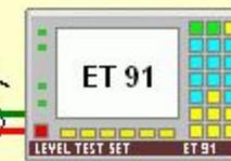
Микропрерывание фиксируется, если принятый тестовый тон по уровню ниже порога более 0,6 мс. Все микропрерывания делятся на 5 категорий согласно длительности
