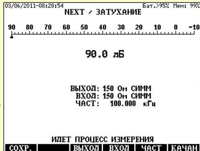
ET91 обеспечивает измерение переходов на симметр. и коаксиальных нагрузках, передавая по L2, а принимая по L1.
