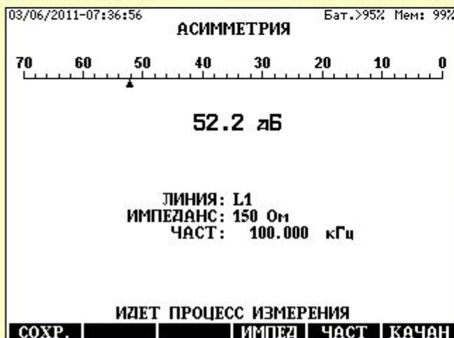
ET91 обеспечивает измерение затухания асимметрии (LCL) согласно ITU-T. Rec.0.9
