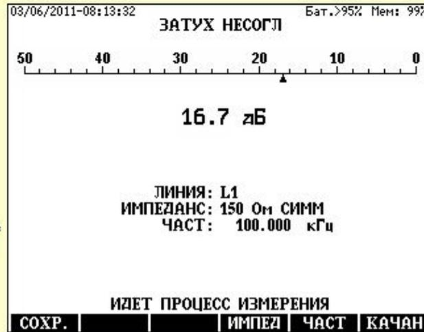
ET91 обеспечивает измерение возвратных потерь на симм. и коаксиальных нагрузках в режиме "Фиксированная частота" или в режиме "Качающаяся частота" без дополнительного внешнего адаптера
