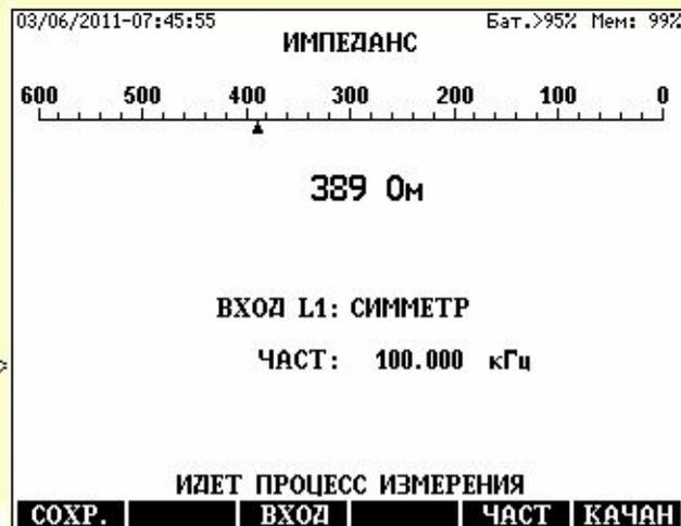
ET91 обеспечивает измерение импеданса на симметрич. и коаксиальных нагрузках в режиме "Фиксированная частота" или в режиме "Качающаяся частота" без дополнительного внешнего адаптера
