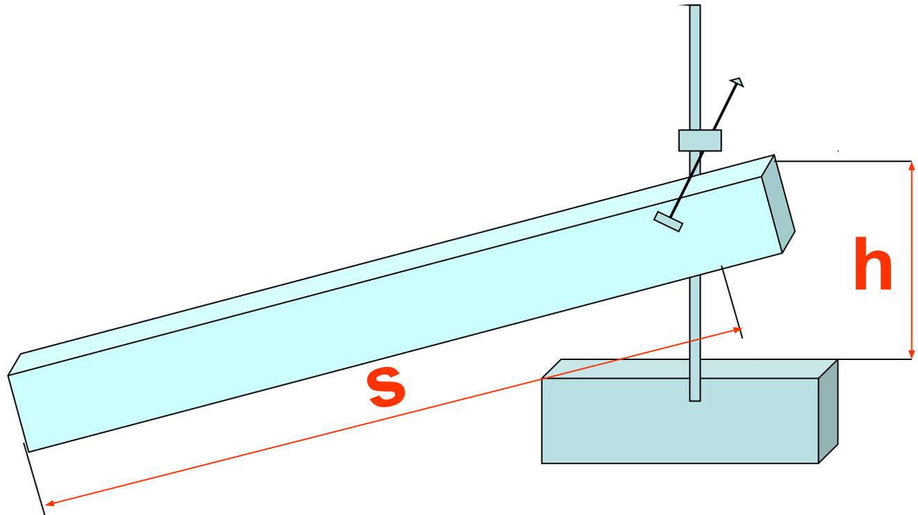
**6. Измерьте с помощью линейки путь  $S$ , который проделал брусок, и высоту  $h$**
