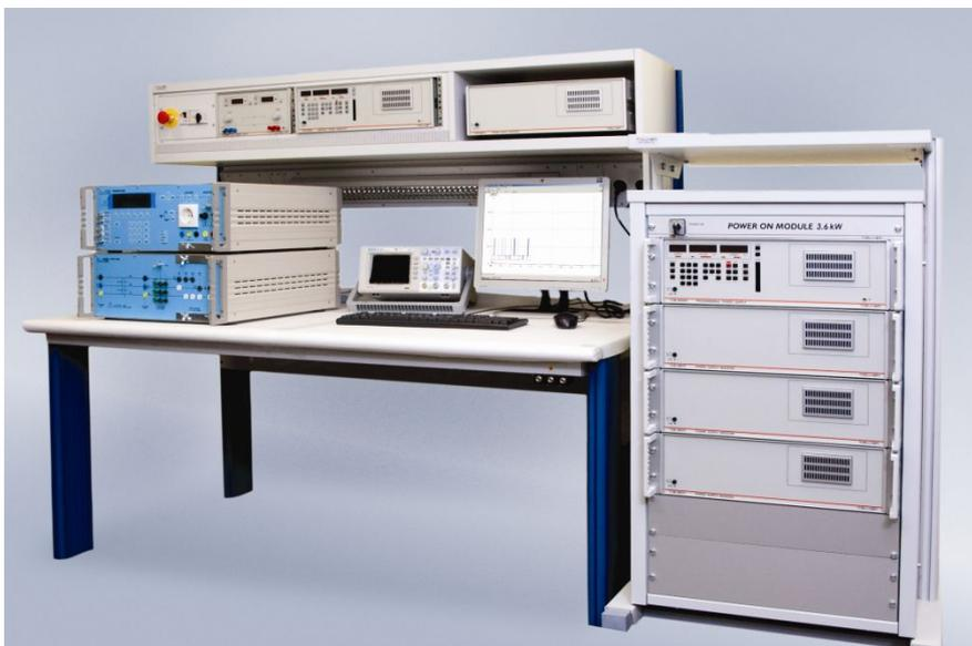
Испытания бортовой аппаратуры на надежность работы в условиях нестабильности и помех в сетях электропитания по ГОСТ 19705-89, КТ-160, ГОСТ В 21134-75, ГОСТ В 21999-86, ГОСТ 28751- 90, ГОСТ РВ 51937-2002, ГОСТ Р 5137.4.11 -99, ГОСТ В 24425-80 и др.
