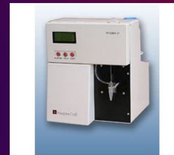
Биохимический анализатор с проточной кюветой АБ-02 "УОМЗ"
