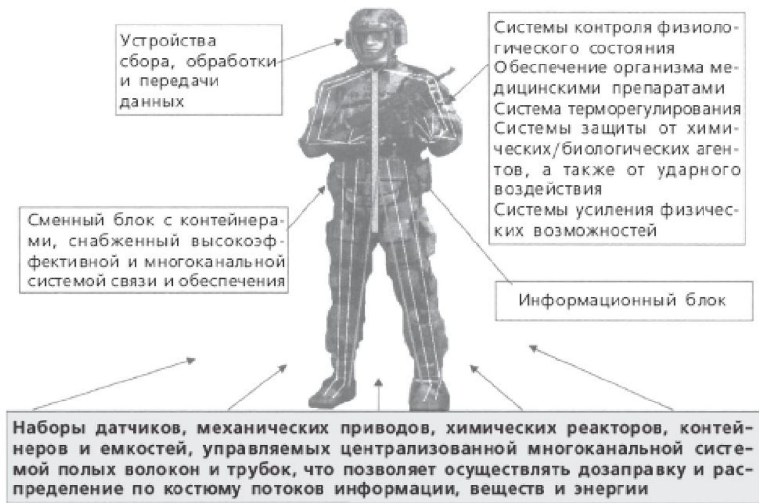
Рис. 3.2. Структура боевой экипировки, разрабатываемой Институтом нанотехнологии для солдат (воспроизводится с разрешения ISN)
