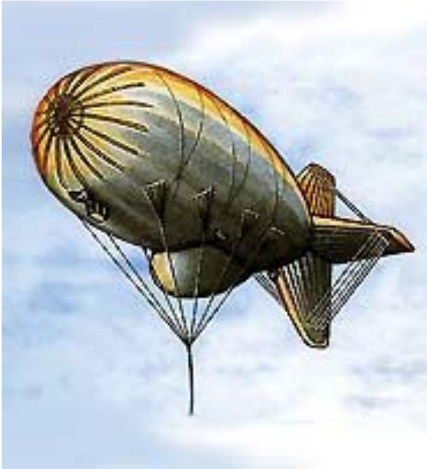
**АЭРОСТАТ** (от греч. aer — воздух и statos — стоящий, неподвижный), летательный аппарат легче воздуха. Имеет оболочку, наполненную легким газом (водородом, гелием). Различают привязные, свободные, управляемые (дирижабли) и аэростаты для полетов в стратосферу (стратостаты).
