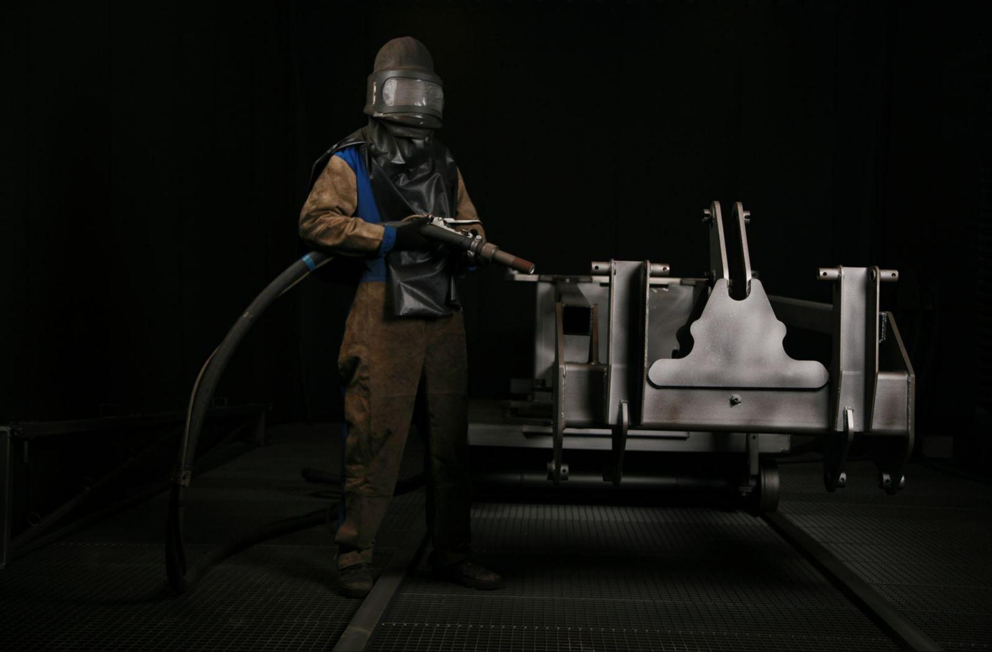
Установка для дробеструйной обработки Schlick позволяет качественно подготовить детали к покраске
