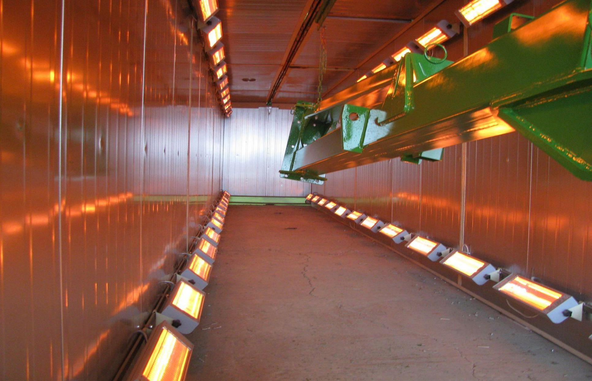
В сушильной камере детали проходят этап просушки
