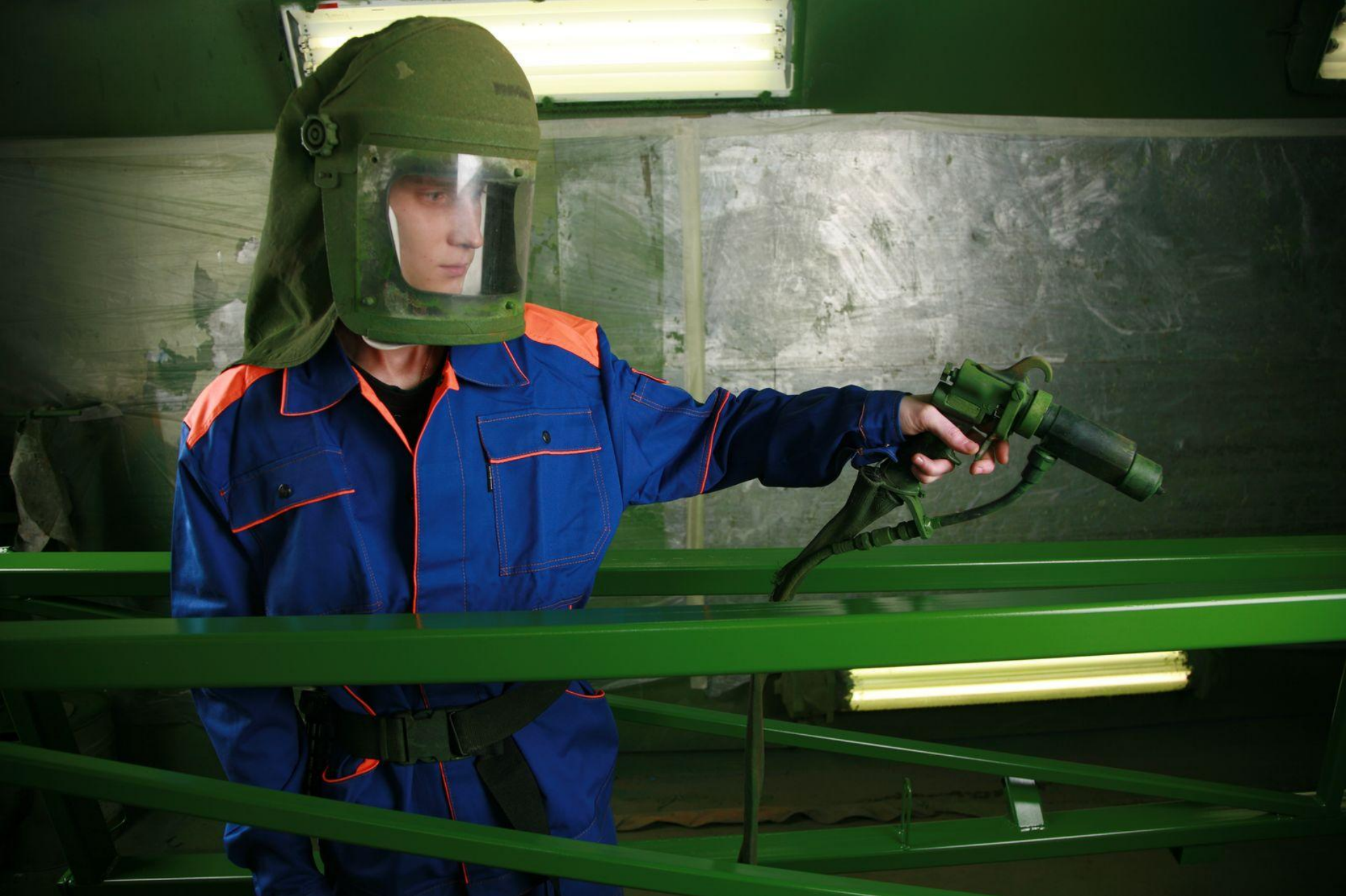
Покраска деталей осуществляется в специальной покрасочной камере в электростатическом поле
