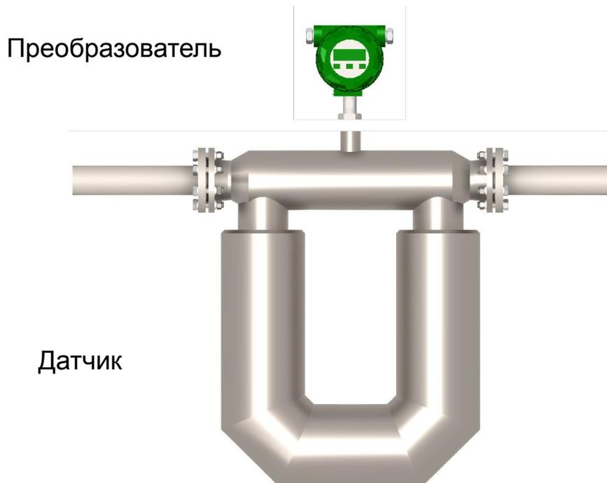
**Датчик** определяет расход, плотность и температуру
