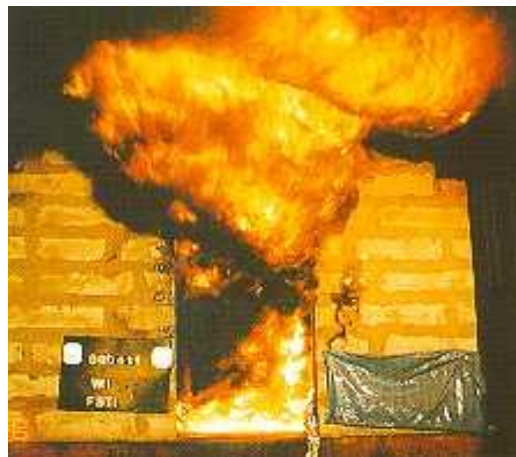
Вспененный пенополистирол 2 мин.
