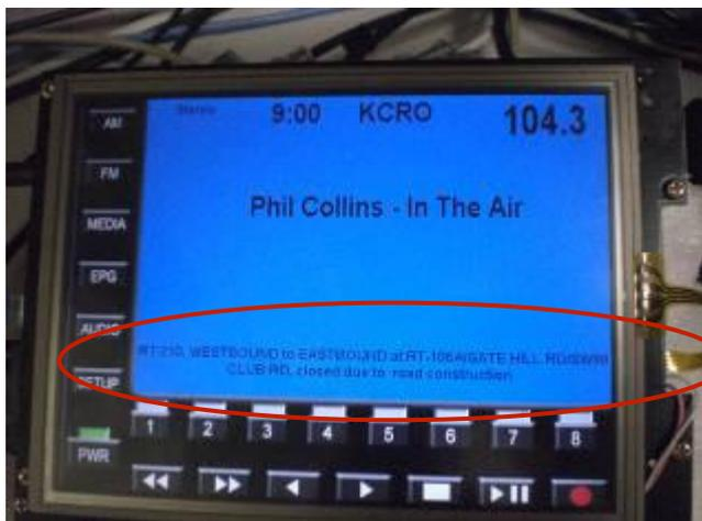
**DTP** – Поддерживаемая новыми HD Radio ICs (чипами) возможность передачи и приёма цифрового контента не аудио формата, а также другой полезной информации, в том числе постоянных обновлений о ситуации на дорогах для автомобильных навигационных систем.
