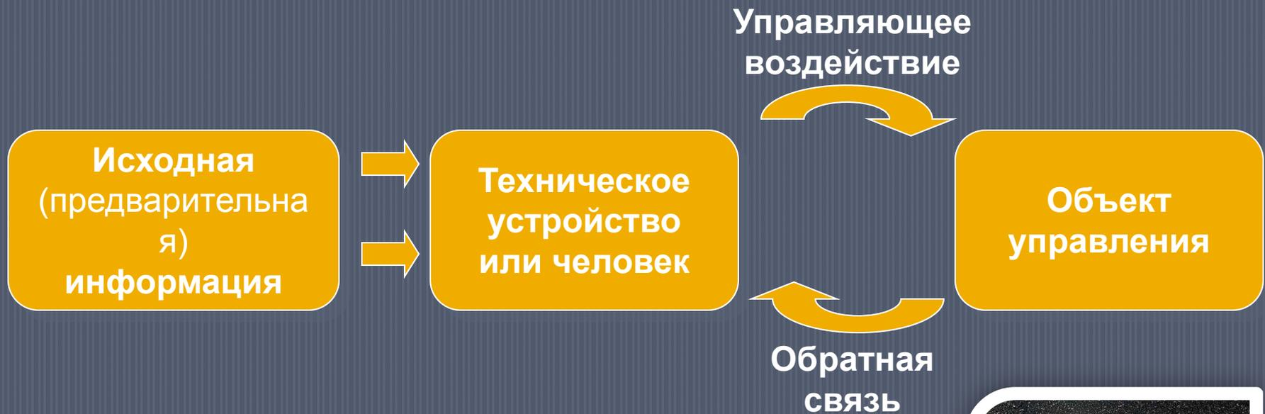
В замкнутых системах автоматического регулирования управляющее воздействие формируется в непосредственной зависимости от управляемой величины. Связь входа системы с его выходом называется **обратной связью**.
