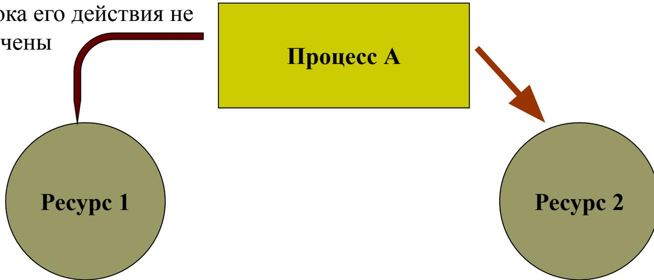
Ресурсы 1 и 2 – ресурсы с эксклюзивным доступом и не допускают использование более чем одним процессом в один момент времени
