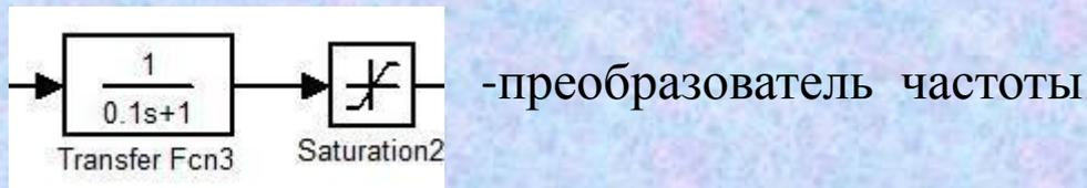
Постоянная времени преобразователя зависит от его инерционности и принимается равной 0.1-0.5, в данном случае принимается постоянная времени, равная 0.1.
