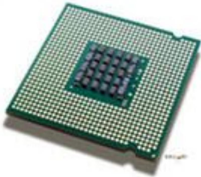
**Мозг системного блока, выполняет логические операции. От его скорости, частоты во многом зависит быстродействие компьютера и вся его архитектура.**
