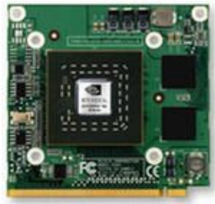
**Плата внутри системного блока, предназначенная для связи системного блока и монитора, передает изображение на монитор и берет часть вычислений на себя по подготовке изображения для монитора. От видеокарты зависит качество изображения.**
