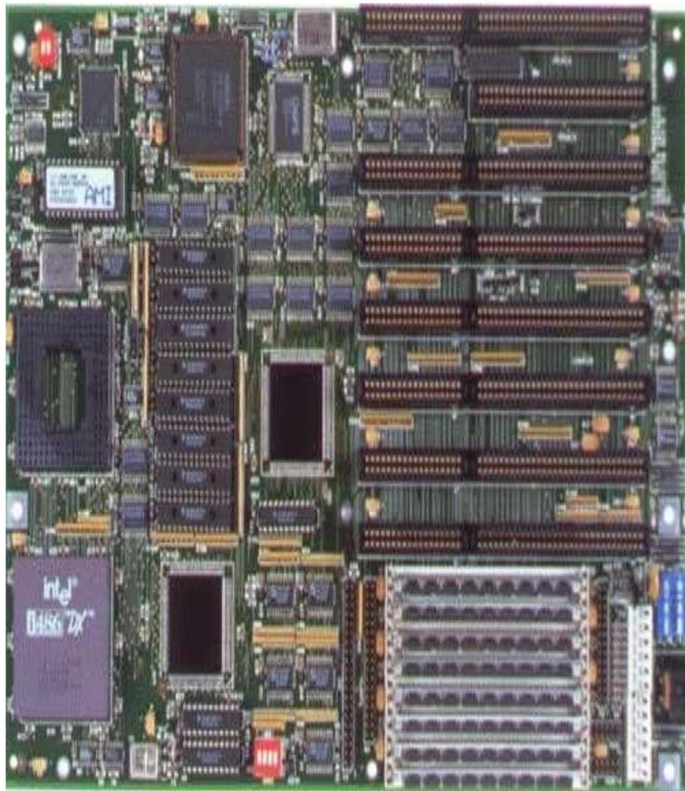
**Основная часть системного блока, к которой подключены все устройства системного блока. Через материнскую плату происходит общение устройств системного блока между собой, обмен информацией, питание электроэнергией.**
