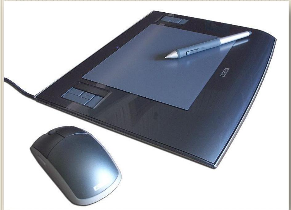
**Графический планшет** (от англ. *graphics tablet* или *graphics pad*, *drawing tablet*, *digitizing tablet*, *digitizer* - *дигитайзер*, *диджитайзер*) — это устройство для ввода рисунков от руки непосредственно в компьютер. Состоит из пера и плоского планшета, чувствительного к нажатию или близости пера. Также может прилагаться специальная мышь.
