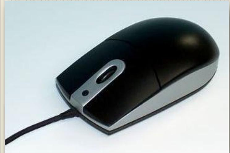
Качество мыши определяется ее **разрешающей способностью**, которая измеряется числом точек на дюйм – dpi (dot per inch). Для мышей среднего класса разрешение составляет 400 – 800 dpi.
