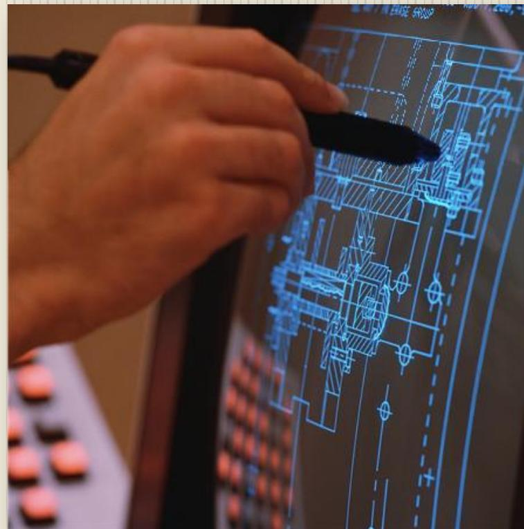
Внешне имеет вид карандаша, соединённого проводом с компьютером. Ввод данных с помощью светового пера заключается в прикосновениях или проведении линий пером по поверхности экрана монитора. В наконечнике пера устанавливается фотоэлемент, который регистрирует изменение яркости экрана в точке, с которой соприкасается перо.
