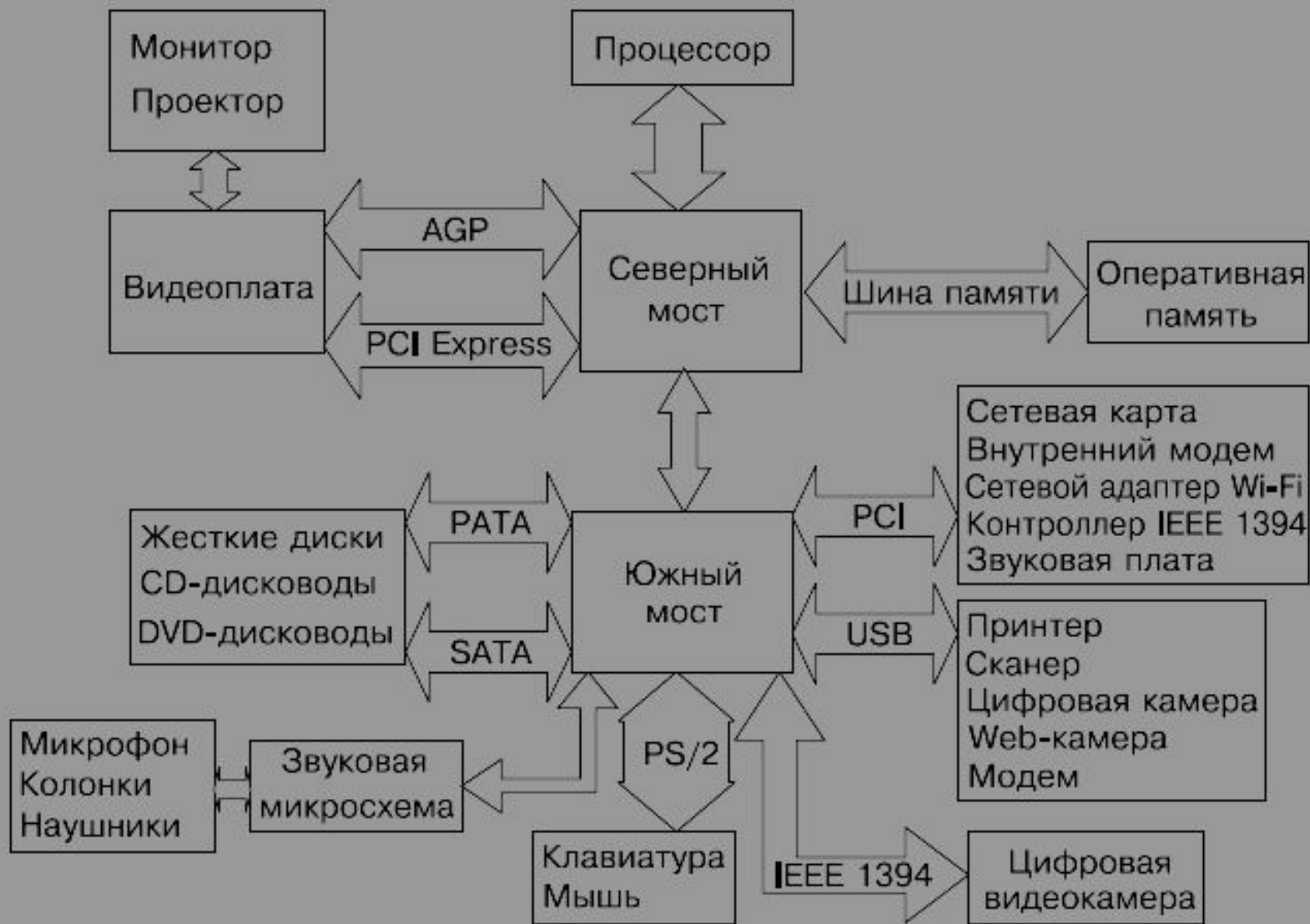
Логическая схема системной платы
