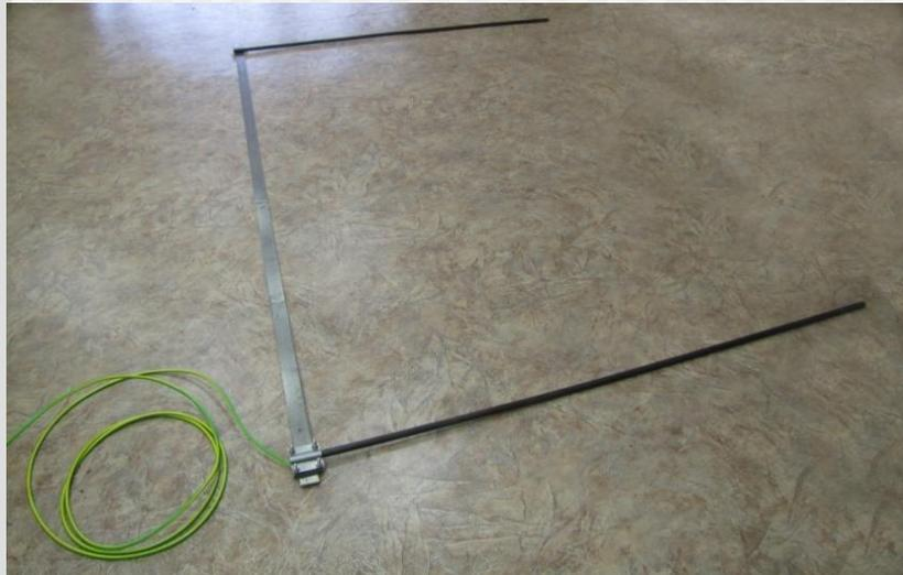
Заземляющие устройства удовлетворяют требованиям ГОСТ Р 50571.10-96 (МЭК 364-5-54) «ЗАЗЕМЛЯЮЩИЕ УСТРОЙСТВА И ЗАЩИТНЫЕ ПРОВОДНИКИ». В общем случае заземляющее устройство может состоять из горизонтальных заземлителей, вертикальных заземлителей или их комбинации. Горизонтальный заземлитель состоит из соединенных между собой полос (секций), изготовленных из нержавеющей стали. Вертикальный заземлитель состоит из соединенных между собой стержней (секций), изготовленных из нержавеющей стали.
