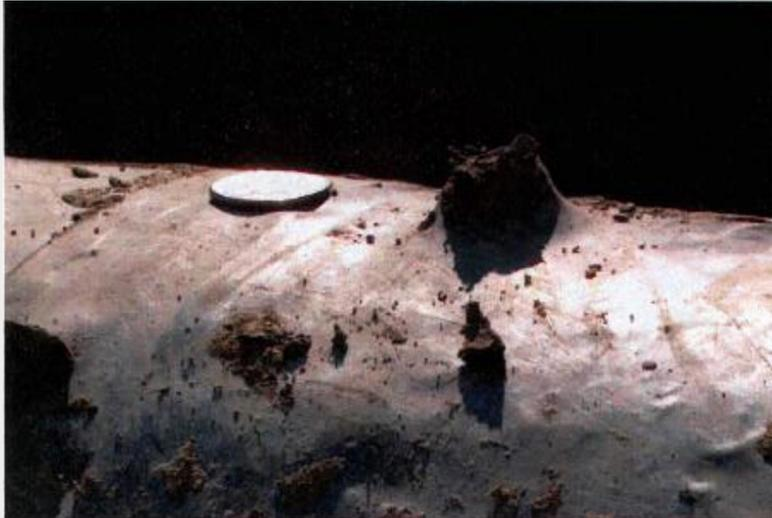
Появление переменного тока в трубопроводе может приводить к смещению защитного потенциала, создаваемого системой электрохимической защиты, в положительную область, что приводит к электрохимической коррозии под действием переменного тока.
