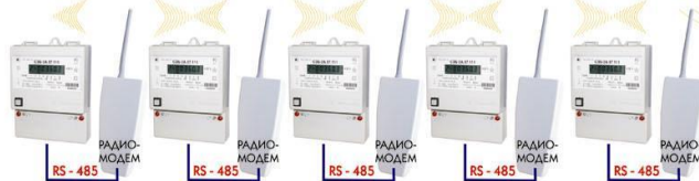
Структурная схема передачи данных через интерфейс RS-485
