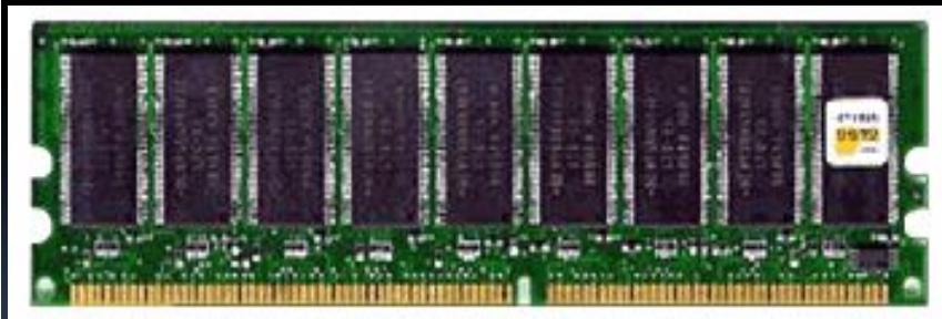
**Оперативная память (ОЗУ)** - это основная память компьютера, предназначенная для хранения текущих данных и выполняемых программ, а также копий отдельных модулей операционной системы. Большинство программ в процессе выполнения резервируют часть оперативной памяти для хранения своих данных. К данным, хранящимся в оперативной памяти, ЦП может обращаться непосредственно, используя хост-шину. После отключения питания компьютера все содержимое ОЗУ стирается.
