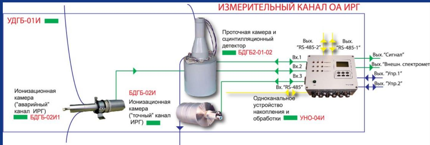
состоит из блоков детектирования на базе ионизационных камер (БДГБ-02И объемом 10 л – чувствительный канал, БДГБ-01И1 объемом 0,1 л – аварийный канал), проточной камеры и ППД (БДГБ-03И) и устройства накопления и обработки УНО-04И
