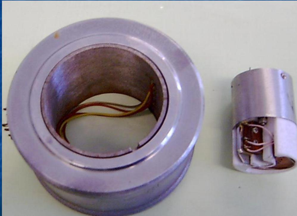
Электроконтактные устройства с применением жидкометаллического материала
