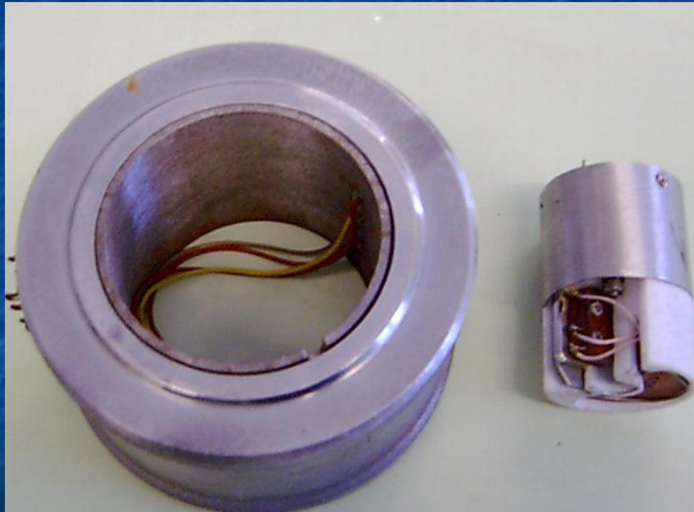
Электроконтактные устройства с применением жидкометаллического материала
