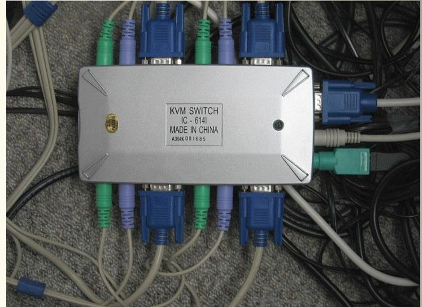
Кроме непосредственно переключения сигнала, KVM-переключатель также должен эмулировать присутствие устройств на отключенных портах, чтобы в отключенных машинах не возникало ошибок, связанных с их опросом. Это стало возможным благодаря наличию общепринятых стандартов на протоколы обмена по шинам D-sub, PS/2 и USB.
