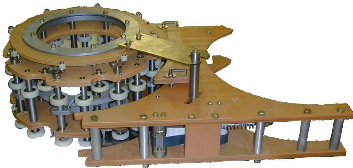
Устройство ориентации предназначено для ориентации круглых бутылок по донному пазу на различных моделях этикетировочных машин.
