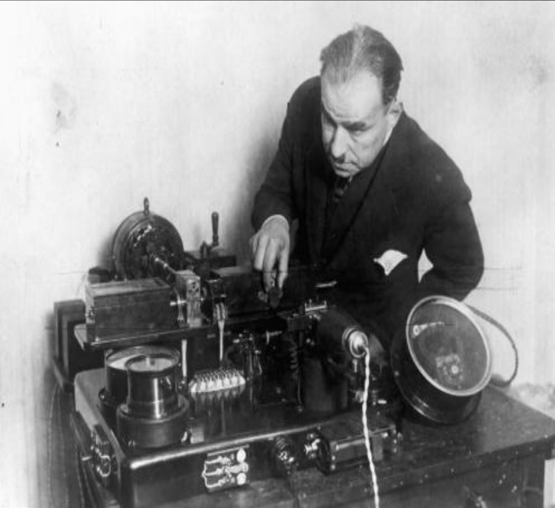
В 1903 г. Артур Корн (Arthur Korn) стал автором первой факсовой сети, объединившей Берлин, Лондон и Париж до 1910 г. Факс-аппараты работали на основе фотоэлектрического сканирования. Используя светочувствительный элемент селен, машины Корна могли преобразовывать разнообразные тоны сканируемого изображения в разные электрические потенциалы. Его работа стала стандартом на десятки лет
