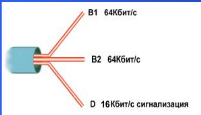
Два В-канала переносят основную часть передаваемой цифровой информации.
