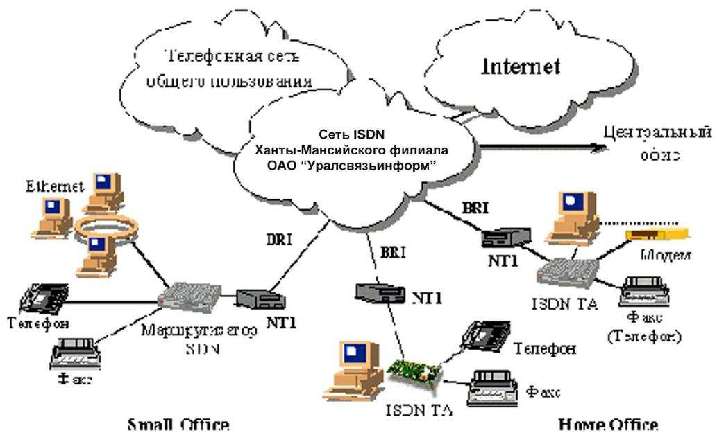
**BRI** (Basic Rate Interface) - интерфейс базового доступа сети ISDN - 64/128 Кбит/с.
