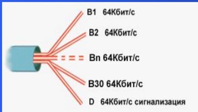
PRI обеспечивает скорость передачи 2,048 Мбит/с и используется для подключения офисной АТС с функциями ISDN или маршрутизатора. Маршрутизатор обычно устанавливают в центральных офисах в больших корпоративных сетях.
