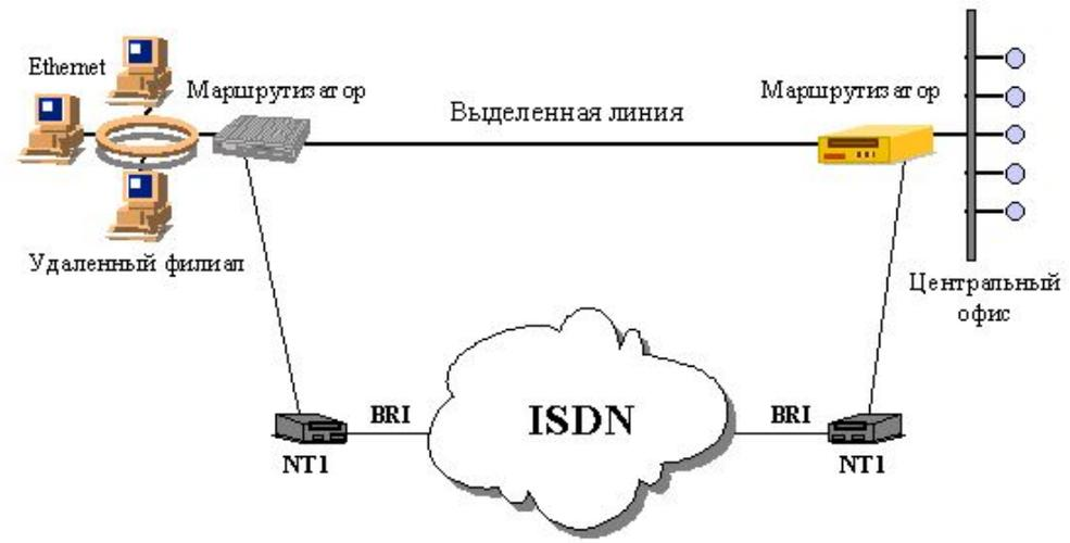
**BRI (Basic Rate Interface)** - интерфейс базового доступа сети ISDN - **64/128 Кбит/с**
