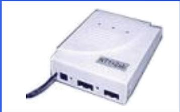
**Сетевое окончание ISDN - NT1** (Network Termination) это сетевое соединительное устройство, обеспечивающее переход с двухпроводных линий ISDN на четырехпроводные для подключения к компьютерам и терминалам. Оно устанавливается оператором связи в помещении клиента.
