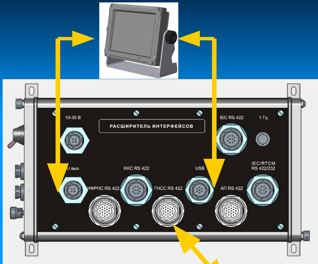
Подключение внешних навигационных датчиков (АИС, РЛС, Эхолот, Крсоуказатель, Лаг и др.)
