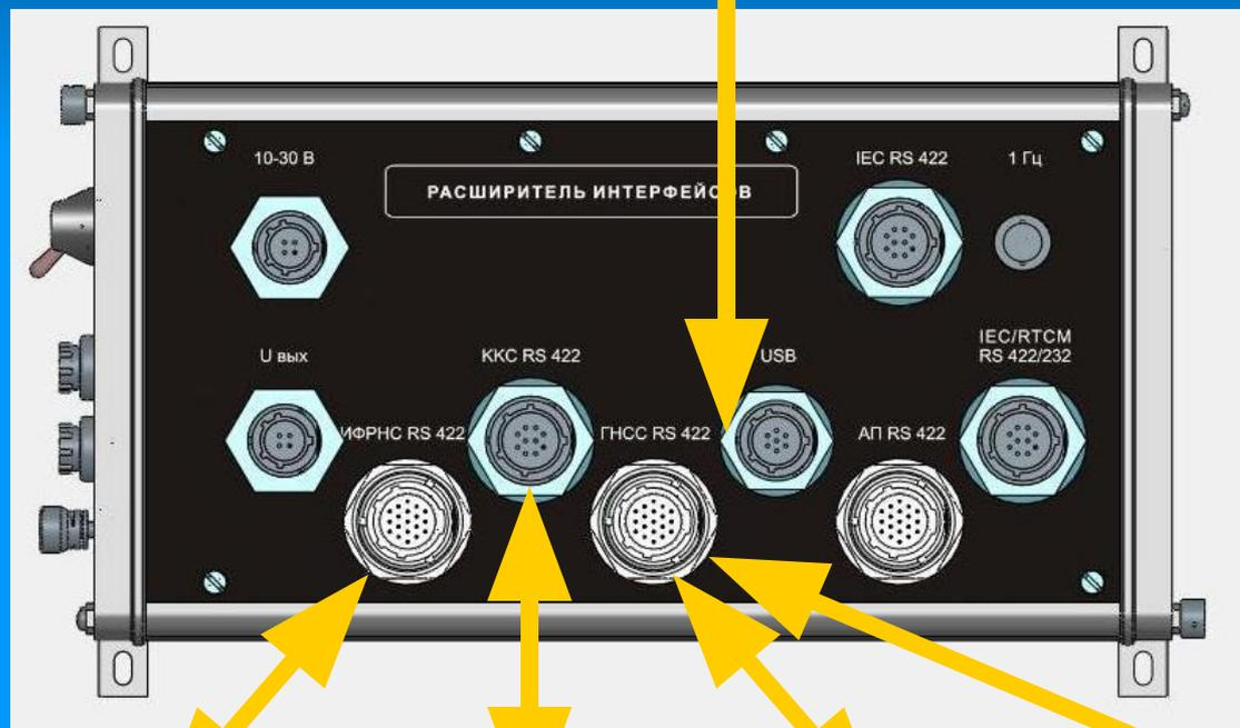
Подключение внешних навигационных датчиков (АИС, РЛС, Эхолот, Крсоуказатель, Лаг и др.)
