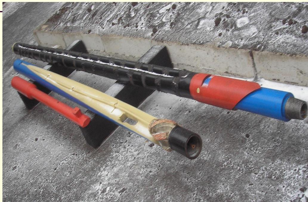
**Вырезание «окна» в обсадной колонне для последующего бурения дополнительного бокового ствола**
