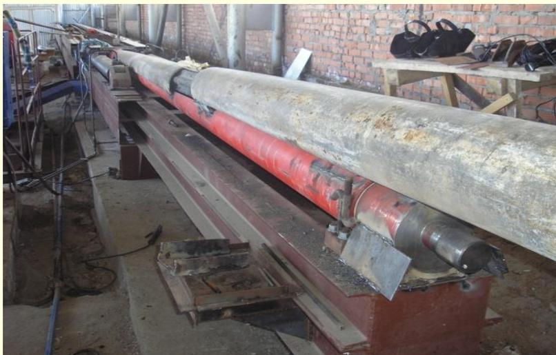
**Крепление хвостовика и герметизации места соединения главного и бокового стволов**
