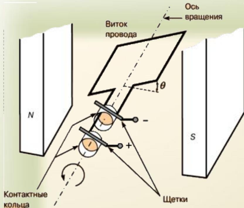
Это устройство, в котором механическая энергия переходит в электрическую
